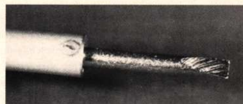
Afb. 2: Voordat de soldeerbout voor het eerst in gebruik wordt genomen, schitteren de metalen delen als zilver. Rechts de vernikkelde soldeerstift. In het midden ziet men de bevestigingsschroef. Daarmee wordt de soldeerstift in het links zichtbare verwarmingselement vastgehouden.
