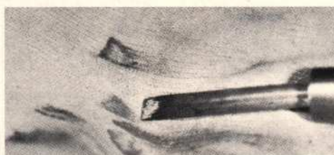
Afb. 5: Omdat het vloeimiddel niet altijd volledig verdampt, vormt zich op de soldeerstift tenslotte een zwarte korst. Deze moet - het beste met een droge, zachte doek - steeds weer even worden afgeveegd.
