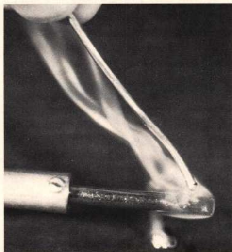
Afb. 4: Het is eigenlijk volkomen normaal, wanneer de soldeerstift de eerste keer bij het vertinnen in zekere zin "nog geen soldeer aannemen" wil. Het gesmolten soldeertin druipt eraf. Alleen al daarom is een geschikt ondergrond ter bescherming van het werktafelblad belangrijk.
