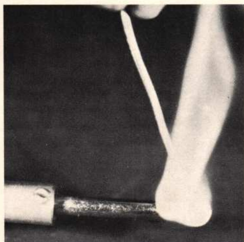
Afb. 3: Ongeveer drie minuten na het inschakelen heeft de soldeerbout de juiste werktemperatuur bereikt. Nu moet de spits worden "vertind". Daarvoor wordt de soldeerdraad tegen de hete spits gehouden. Zoals u ziet, verdampt het zich in de soldeerdraad bevindende vloeimiddel. Daarbij wordt de soldeerpunt gereinigd.
