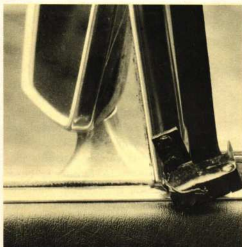
Figuur 2. Microschakelaar ter beveiliging van het zijruitje.
